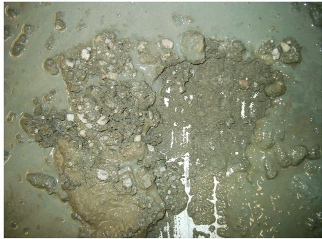
**Bild 2:** Entmischter SVB beim Setzfließversuch nach dem Aufnehmen mit der Kelle
