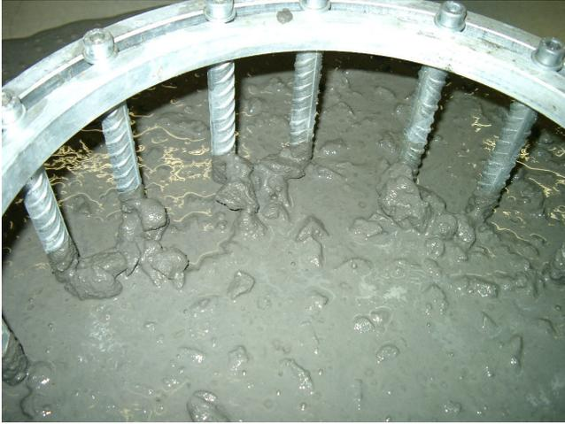
**Bild 1:** Blockierender SVB beim Blockieringversuch
