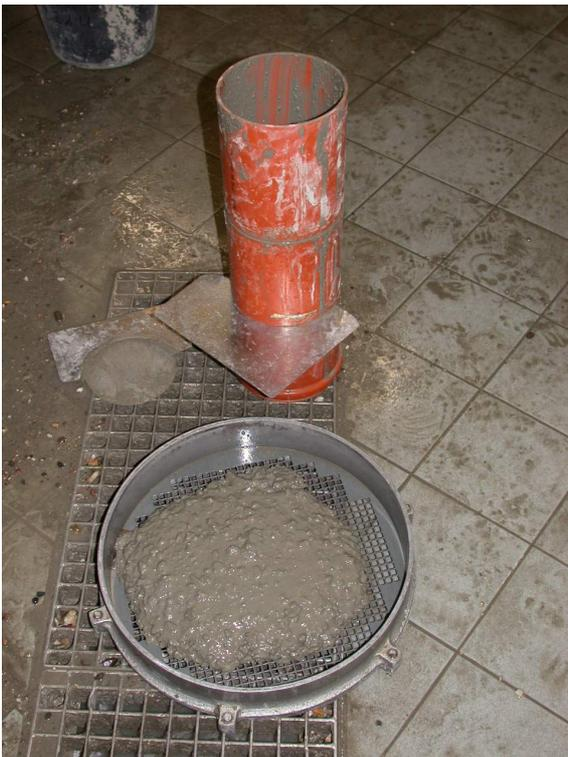
Bild 5: Sedimentationsversuch am Frischbeton
