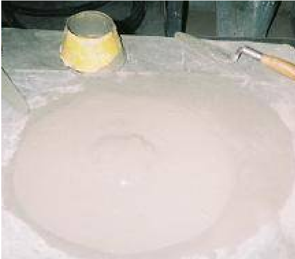
Mini slump cone test
