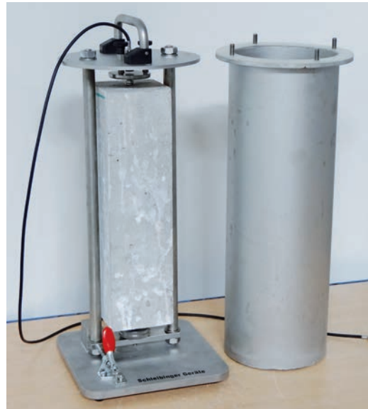
Bild 2 Prototyp des Behälters mit Messrahmen für den Minireaktor Prototype of a container with measurement frame
