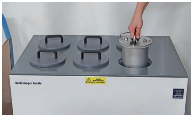
Bild 1 Prototyp des Minireaktors Prototype of the benchtop reactor
