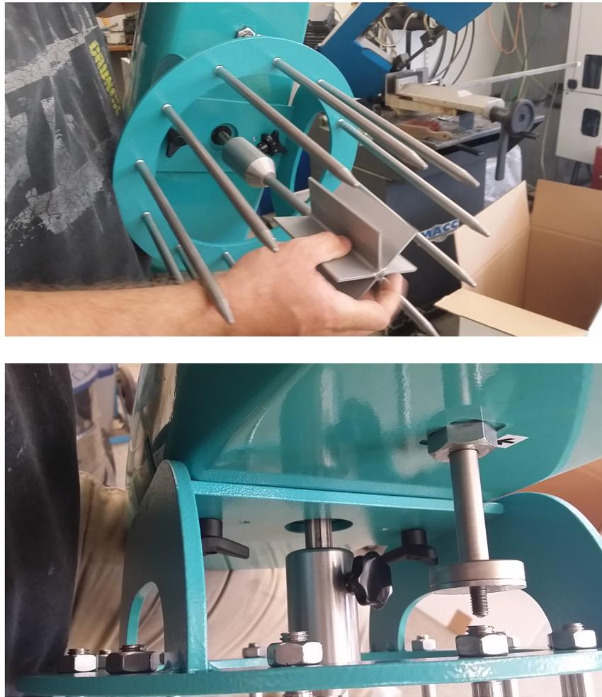
Abbildung 16: Fixieren der Vanesonde am eBT-V.
