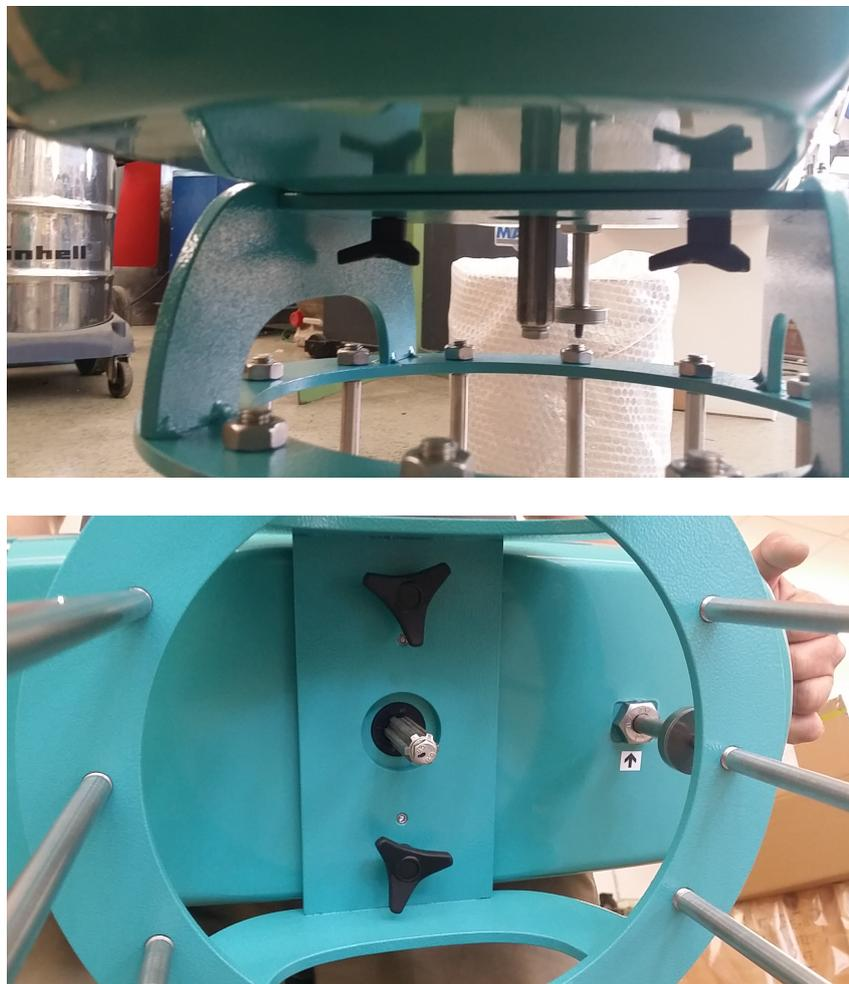
Abbildung 15: Fixieren des Gerätes auf der Gerätehalterung.
