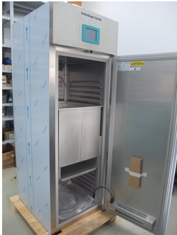
Abbildung 11: Der Slabtester mit dem Innenbehälter
