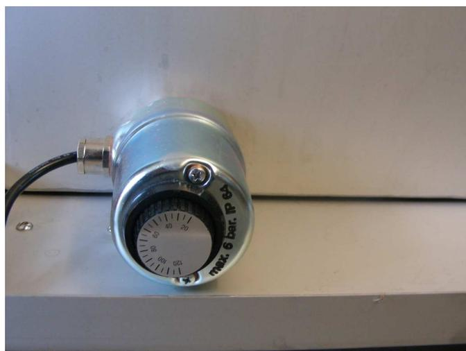
Abbildung 7: Einstellung der Heizpatrone hinten am Außenbehälter
