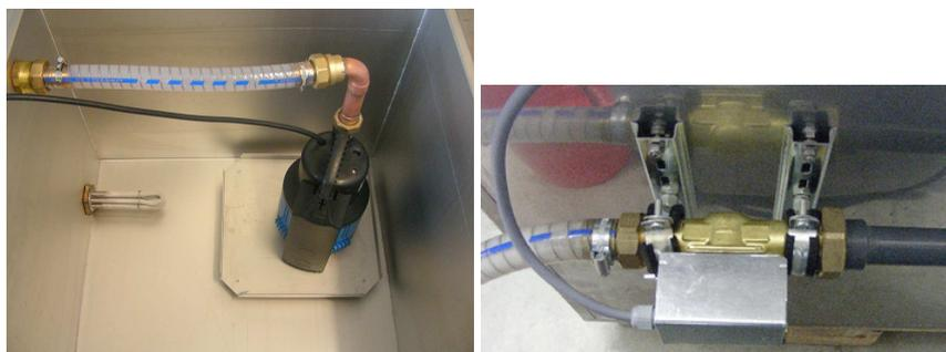
Abbildung 3: Die Pumpe im Außenbehälter und das Motorventil auf der Rückseite des Slabtesters
