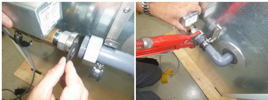
Abbildung 59: Befestigen der Wasserleitung am Motorventil auf der Rückseite von Slabtester.
