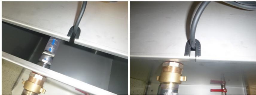
Abbildung 61: Befestigen der Wasserleitung am Außenbehälter und das Einklemmen von dem Pumpenkabel.
