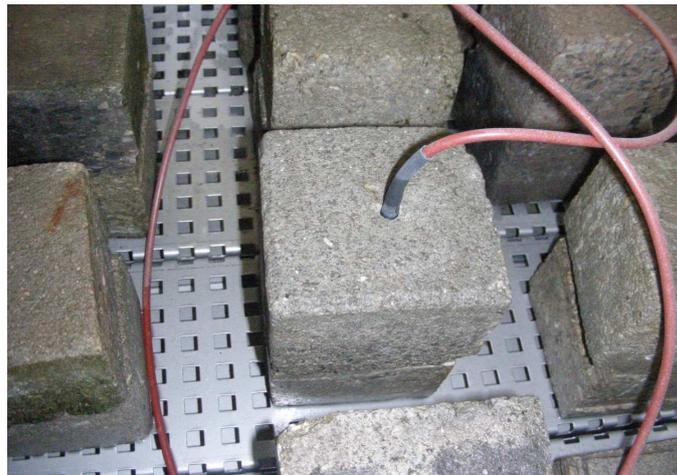
Abbildung 5: Der Innenbehälter der Flutungsoption mit Referenzfühler
