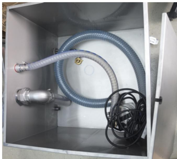
Abbildung 12: Verbindungsschläuche und die Pumpe im Außenbehälter.
