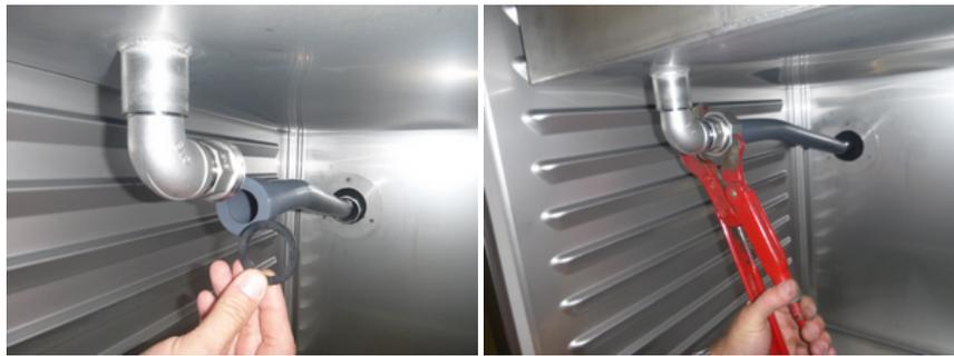
Abbildung 58: Befestigen der Wasserleitung im Slabtester.
