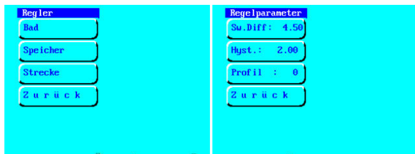
Abbildung 26: Menüpunkt «Regler» (links) und Eingabe der Regelparameter für den Speicher (rechts).
