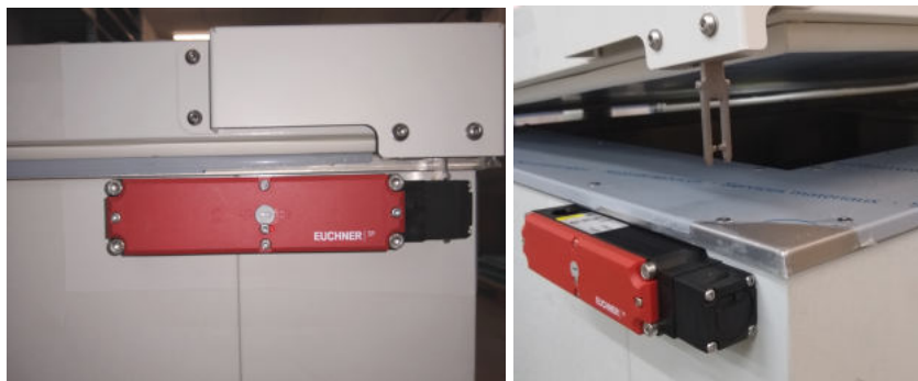
Abbildung 2: Sicherheitsschalter am Deckel auf der linken Seite der Anlage: geschlossene Position (links) und offene Position (rechts).
