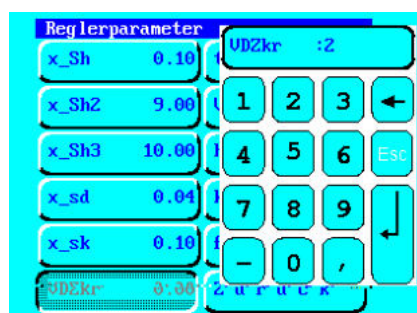
Abbildung 10: Parametereinstellung der Heizung.
