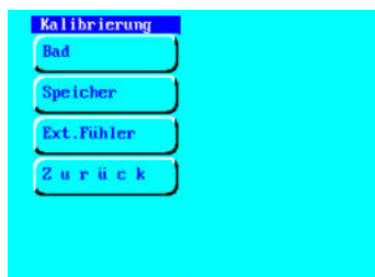
Abbildung 27: Untermenü für die Eingabe der Kalibrierwerte der Temperaturfühler.
