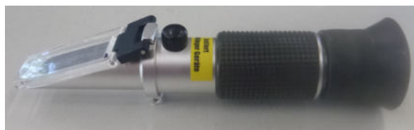
Abbildung 43: Refraktometer (links) und die Anzeige für Frostschutz bei -36 °C (rechts).
