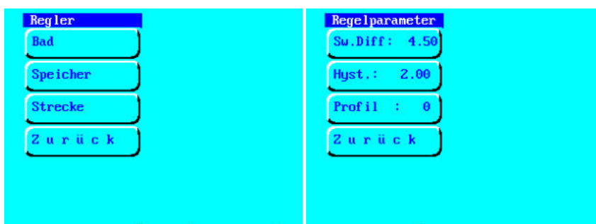
Abbildung 28: Menüpunkt «Regler»(links) und Eingabe der Regelparameter für den Speicher (rechts).
