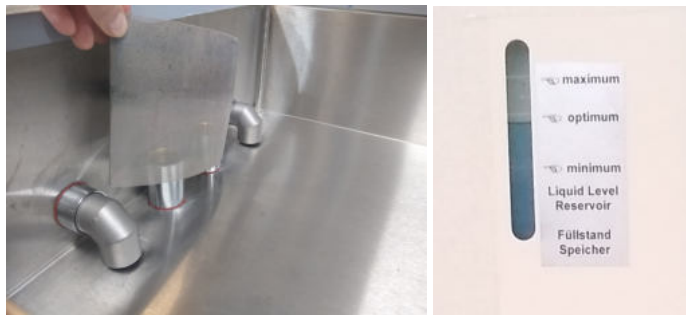
Abbildung 10: Einsetzen des Filters (links) und optimale Füllmenge der Wärmeträgerflüssigkeit in der Anlage (rechts).
