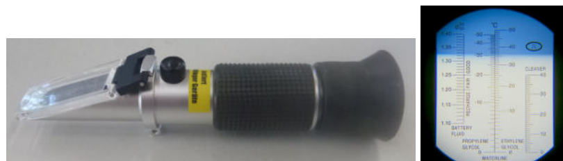
Abbildung 45: Refraktometer (links) und die Anzeige für Frostschutz bei -36\text{ °C} (rechts).
