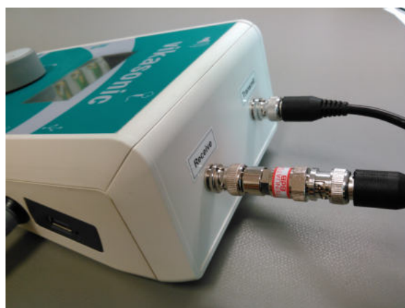
Abbildung 12: Anschluss des US Messbades mit Dämpfungsglied an der Eingangsseite.
