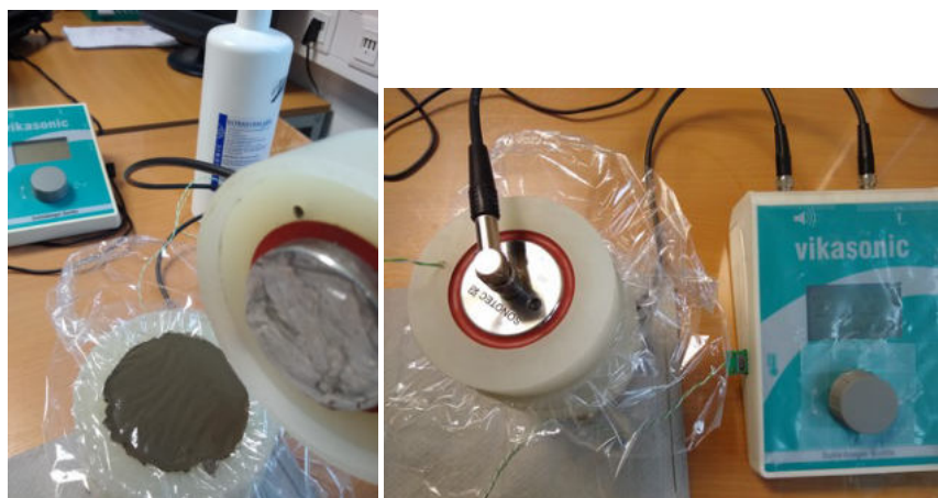
Abbildung 15: Platzieren des Senders auf die Probe in der Messzelle.
