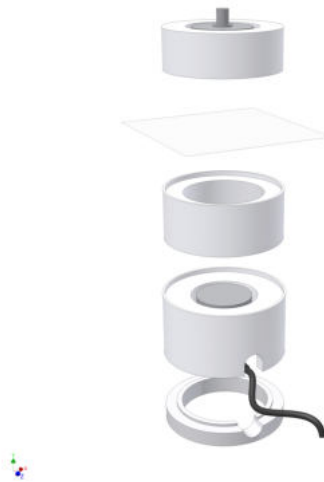
Abbildung 13: Messzelle, bestehend aus Empfänger, Vicatring und Sender
