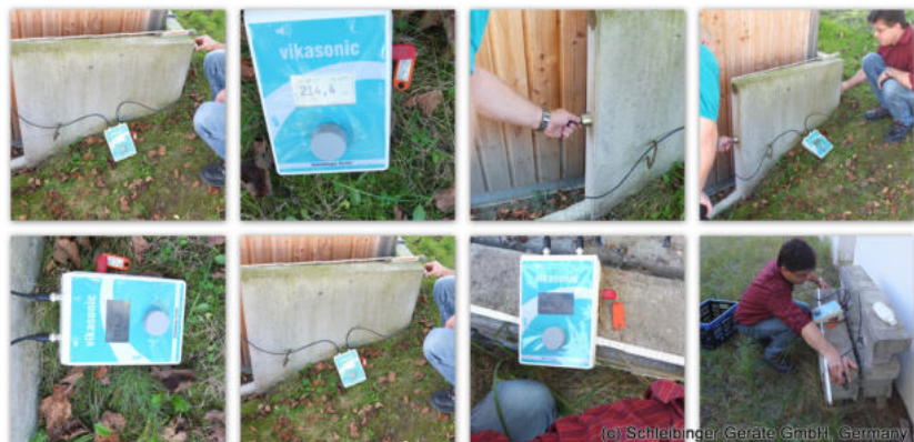
Abbildung 10: Durchschallung von festen Bauteilen.
