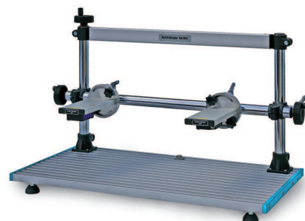
Fig. 8. Sistema de sujeción de los reflectores de medida de la retractibilidad de las capas finas a depositar sobre la base de la bancada.
