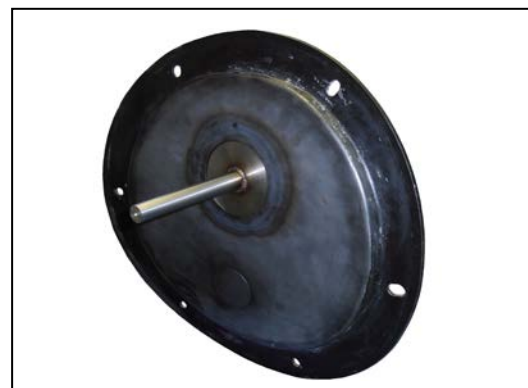
Installation von Mikrowellen-Sonde, Konsistenzmessstab und der Sendeeinheit in der Trommelklappe eines Mischfahrzeugs
